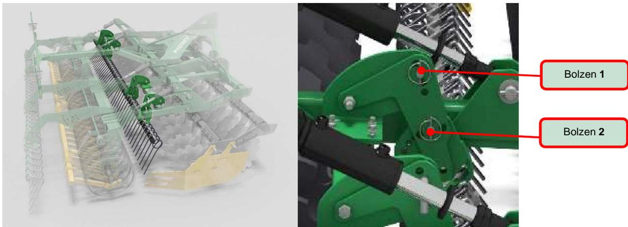
Der Prallstriegel kann durch die Bolzen 1 & 2 in der Neigung und in der Höhe eingestellt werden. Durch das Umstecken von Bolzen 1 kann die Höhe variiert werden. Mit Bolzen 2 wird die Neigung des Striegels eingestellt.
