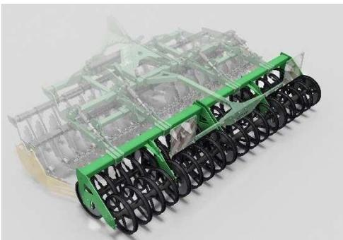
Das U-Profil des Walzenläufers füllt sich während der Feldarbeit mit Erde. Somit wird ein sehr guter Selbstantrieb bei hoher Tragfähigkeit erreicht. Jedoch besteht die Gefahr, dass beim Straßentransport dieses Erdmaterial herausfällt und andere Verkehrsteilnehmer gefährdet!
