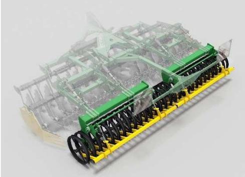
Das U-Profil des Walzenläufers füllt sich während der Feldarbeit mit Erde. Somit wird ein sehr guter Selbstantrieb bei hoher Tragfähigkeit erreicht. Jedoch besteht die Gefahr, dass beim Straßentransport dieses Erdmaterial herausfällt und andere Verkehrsteilnehmer gefährdet! Die Messerschiene wird wie bei den Crackerwalzen eingestellt (s.o.).
