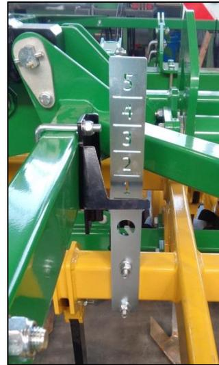
Zur Regulierung der Einstellgeschwindigkeit sind im Hydrauliksystem der Tiefeneinstellung Drosselrückschlagventile verbaut. Die Anpassung ist für das Anheben und Absenken der Zinkenfelder unabhängig voneinander möglich. Madenschrauben in den Einstellkappen der Ventile verhindern ein selbsttätiges Verstellen. Falls eine Anpassung der Werkseinstellung notwendig wird, sind die Madenschrauben zunächst zu lösen.
