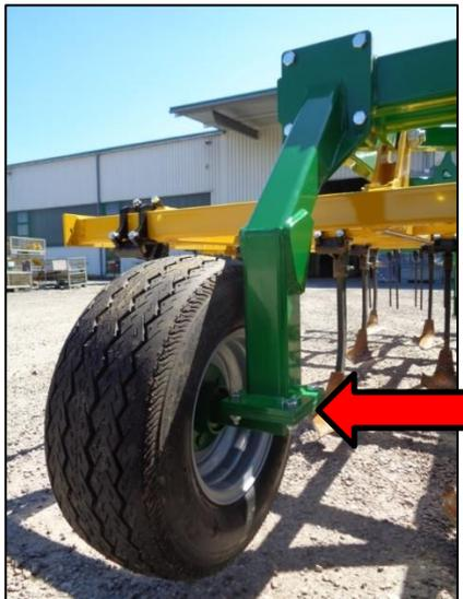
**Achtung!** Das Gewicht der Maschine muss im Feldeinsatz vom Schlepper getragen werden, nicht von den Tasträdern!
