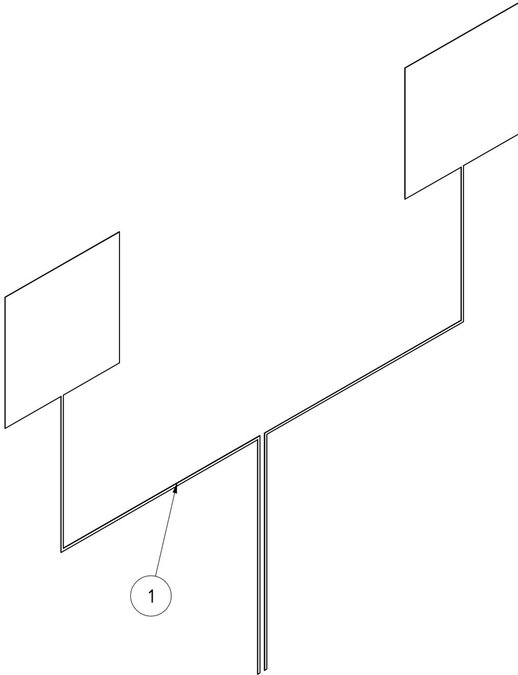
Kabelsatz inkl. Stecker und 1,7m Schutzschlauch
