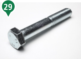
Abscherschraube für Stiel Standard M12x75 DIN 931 8.8 Teile Nr. 931.12.75
