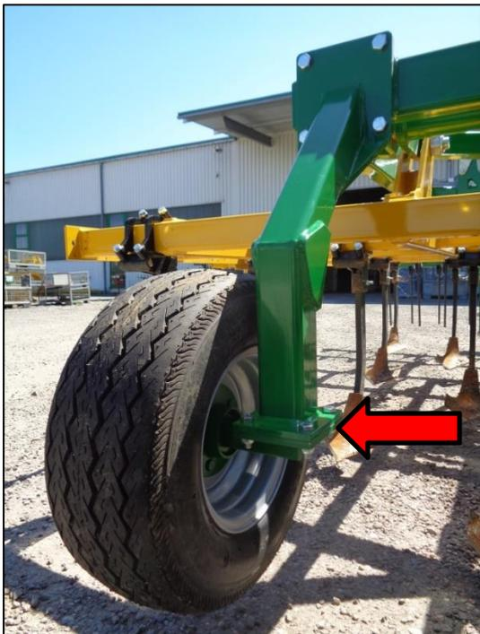
**Achtung!** Das Gewicht der Maschine muss im Feldeinsatz vom Schlepper getragen werden, nicht von den Tasträdern!
