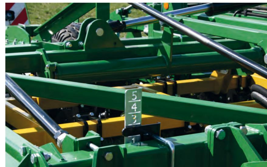
Hydraulische Tiefeneinstellung. Es kann schnell auf unterschiedliche Bodenverhältnisse reagiert werden.
