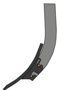
Scharspitze mit Federsteg am Sperrbolzen befestigt
