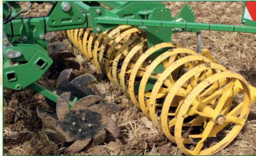
Beim Sternradgrubber Corona sind die Sternverteiler auf einer durchgehenden Querstange montiert, der sogenannten Sternradbank. Über eine Spindel werden alle Sternverteiler auf der Querstange gleichzeitig parallel verstellt. Das spart Zeit und bringt gleichzeitig die notwendige Präzision.
