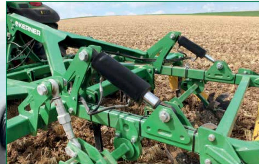
In der Serienausstattung verfügt der Grubber über eine hydraulische Tiefeneinstellung. Es kann bequem über die Arbeitshydraulik am Schlepper die gewünschte Arbeitstiefe eingestellt werden. Dies ist von großem Vorteil, wenn man nur gelegentlich für kritische Stellen auf dem Feld eine andere Arbeitstiefe benötigt. Eine große mechanische Anzeige am Rahmen zeigt das Arbeitsniveau an. So kann man nach Durchfahren der kritischen Fläche wieder zurück auf den normalen Wert regeln.
