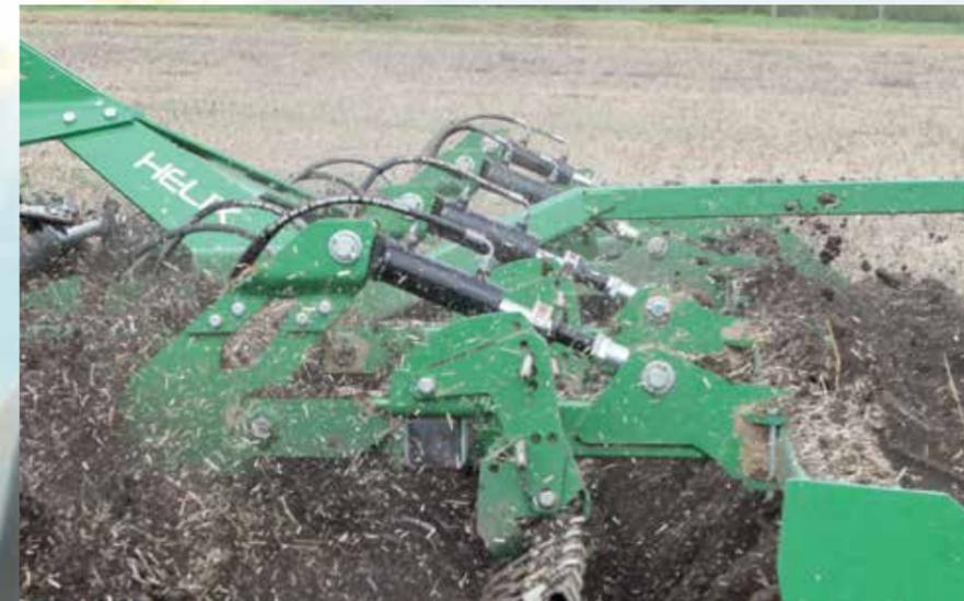
Die Arbeitstiefe wird über Clips oder optional über Hydraulikzylinder eingestellt.
