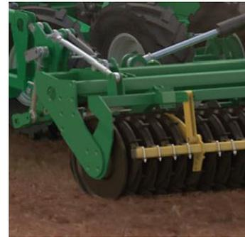
Bei Böden, die leicht zur Verschlammung neigen, empfiehlt es sich die Zwischenmesser etwas nach oben zu stellen, um so den Feinerdeanteil vom Boden zu minimieren. Bei einer gewissen Abnutzung der Messer kann die Grundeinstellung mit der Schraube und einem Lochsystem nachkorrigiert werden.
