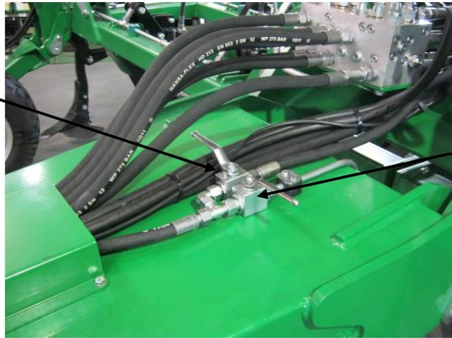
Absperrhahn für hydraulischen Stützfuß (geschlossen im Bild). Der Stützfuß und die hydraulische Steinsicherung werden vom gleichen Schlepperanschluss versorgt.
