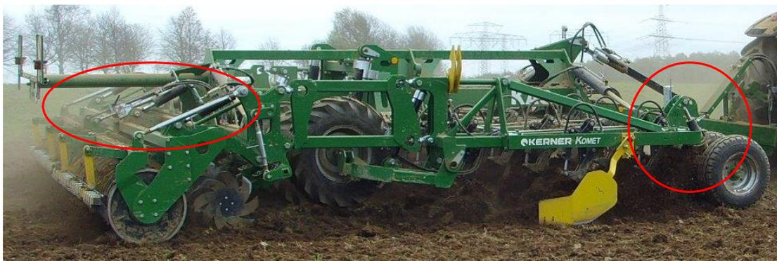
4. **Die Crackerwalzen**, ein Hauptbestandteil zur exakten Tiefenführung, gezielten Zerkleinerung und zur optimalen Rückverfestigung des Bodens.
