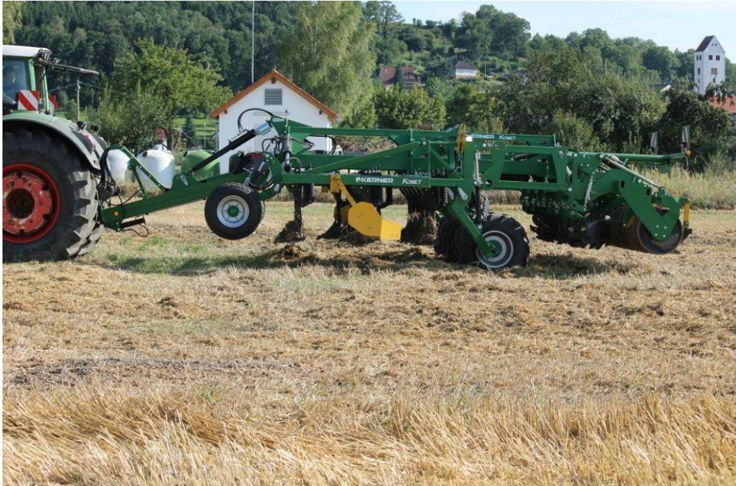
1. Tasträder, 2. 3-teilige Flügelscharen, 3. Fahrwerk 4. Sternverteiler, 5. Crackerwalze
