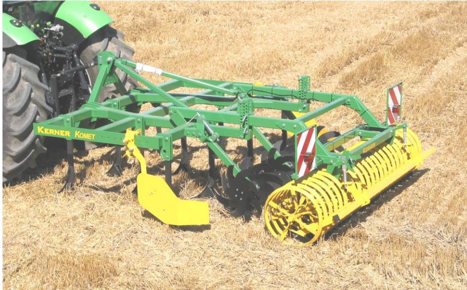
3-balkiger Grubberrahmen mit Flügelscharen, Sternverteiler V-förmig, Crackerwalze
