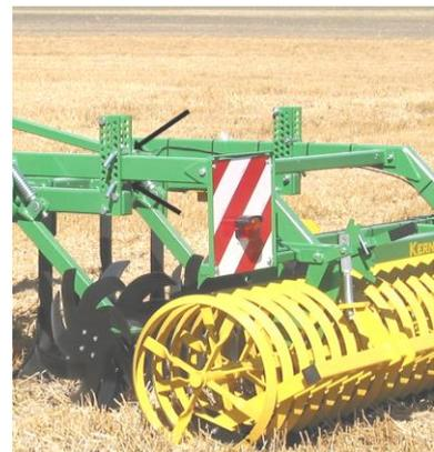
2. Die Sternverteiler können sehr leicht durch eine Gewindespindel in der Höhe verstellt werden. Eine zusätzlich eingebaute Druckfeder ermöglicht eine optimale Boden Anpassung der Sternräder.
