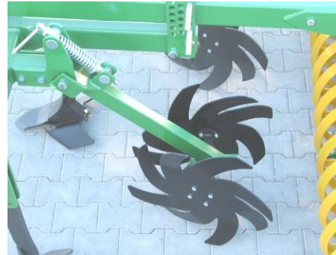
3. **Die Crackerwalzen** Ø 600mm, ein Hauptbestandteil zur exakten Tiefenführung, gezielten Nachzerkleinerung von verbleibenden Schollen und zur optimalen Rückverfestigung des Bodens, ist am Ende des Sternradgrubbers mit dem Rahmen verschraubt.
