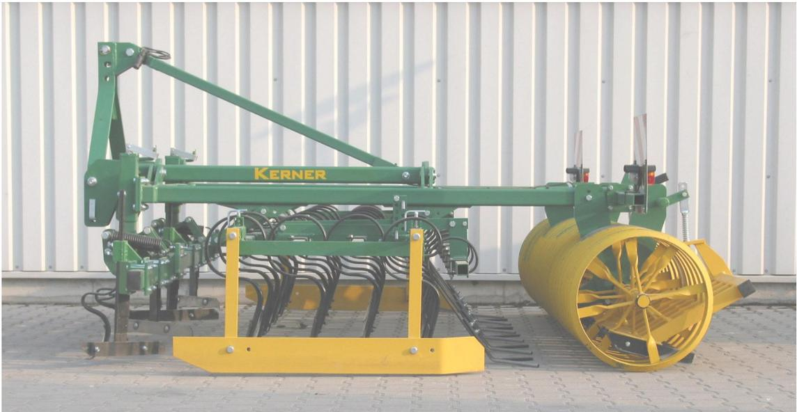
gefederte Planierschiene mit Blattfederzustreicher; Eggenfelder über Spindel verstellbar; V-Zustreicher; Crackerwalze
