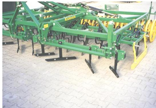
3. Der Spurlockerungssatz (Sonderausrüstung) wird in seiner Arbeitstiefe so eingestellt, dass die Schlepperspuren im Bereich 3-5 cm gut aufgelockert werden.
