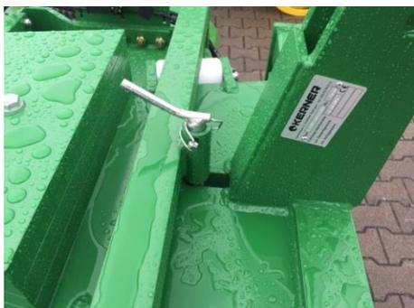
**Abbildung 4: Arretierbolzen Lenkbock**
