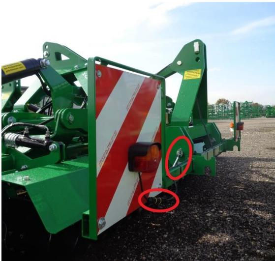
Abbildung 5: Beleuchtungshalter mit Bolzen und Steckverbindung
