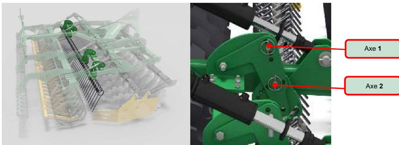
La herse peigne peut être réglée en inclinaison et en hauteur à l'aide des axes 1 & 2. En changeant de position de l'axe 1, la hauteur de la herse peut être réglée. L'axe 2 permet quant à lui de régler son inclinaison.
